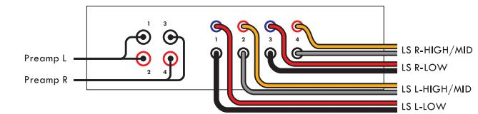
Für den Bi-Amping-Betrieb benötigen Sie pro Kanal ein ROWEN-Kabel Cinch auf 2 Cinch für die Verbindung zwischen Vorverstärker und PA4 Endverstärker.
