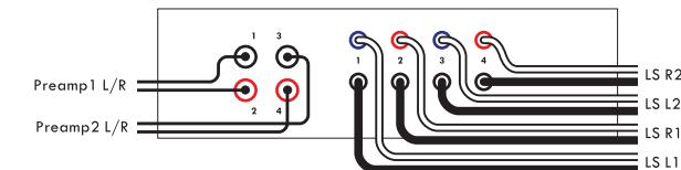
Für den 4-Kanal-Betrieb benötigen Sie ROWEN-Cinch-Kabel für die Verbindung zwischen Vorverstärker und PA4 Endverstärker.
