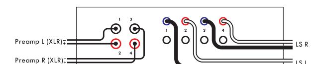
Für den symmetrischen Betrieb mit vierfacher Leistung benötigen Sie pro Kanal ein ROWEN-Absolute XLR auf 2 Cinch Kabel für die Verbindung zum ABSOLUTE PRE Vorverstärker. Bei Vorverstärkern, die keinen echt symmetrischen Ausgang aufweisen, benötigen Sie ein ROWEN SYM4 Transformer Modul.
