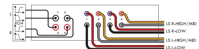
Für den Bi-Active-Betrieb benötigen Sie ein ROWEN XO4 Crossover Modul für die Verbindung zwischen Vorverstärker und PA4 Endverstärker.
