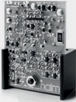
Nous avons depuis longtemps pu constater l'importance d'une alimentation propre, stable et à faible niveau de bruit pour le résultat d'écoute. Notre technologie DR (Discrete Regulator), tout d'abord intégrée dans nos alimentations et désormais présente dans Statement et nos amplificateurs de puissance, est l'expression ultime de cette philosophie.
