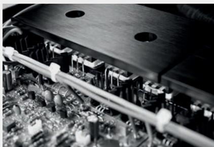
Tous les composants des produits Naim passent sous la loupe de nos ingénieurs. L'emplacement et la configuration des câbles de signal et d'alimentation d'un produit sont très importants. Si vous faites passer une ligne de signal audio sensible près d'une ligne d'alimentation bruyante par exemple, il en résultera du bruit et une distorsion.
