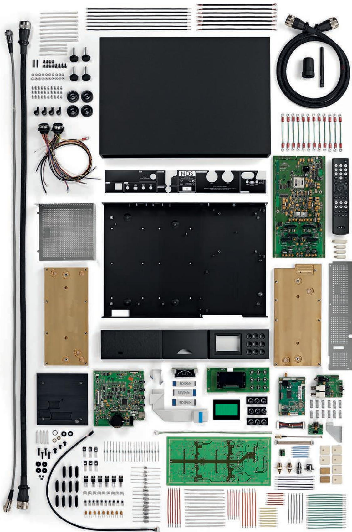
Avant assemblage : le lecteur réseau NDS est constitué de 620 pièces, assemblées par des techniciens hautement qualifiés de façon à offrir la cadence, le rythme et la synchronisation caractéristiques de Naim.
